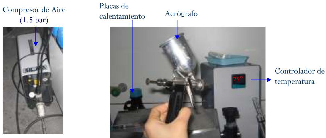
**Fig. 3.7.** Dispositivos utilizados para el depósito del material electrocatalítico sobre la membrana de Nafion 117 mediante la técnica de Hot-Spray.
