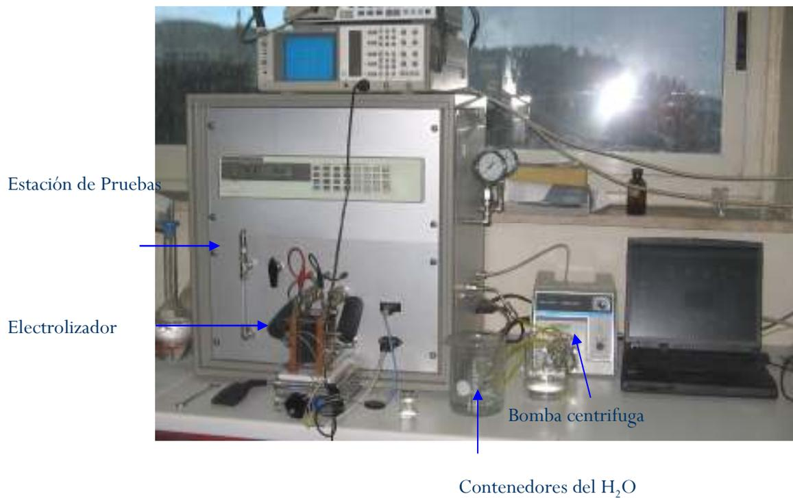
**Fig. 3.9.** Estación de pruebas utilizado para la caracterización de la celda.
