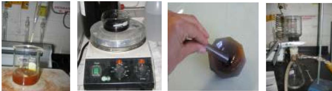
**Fig. 3.1** Procedimiento en la síntesis del precursor. a).disolución de las sales acuosas b). Obtención de la pasta c). Pulverización de los polvos d). Lavado y filtrado del precursor.
