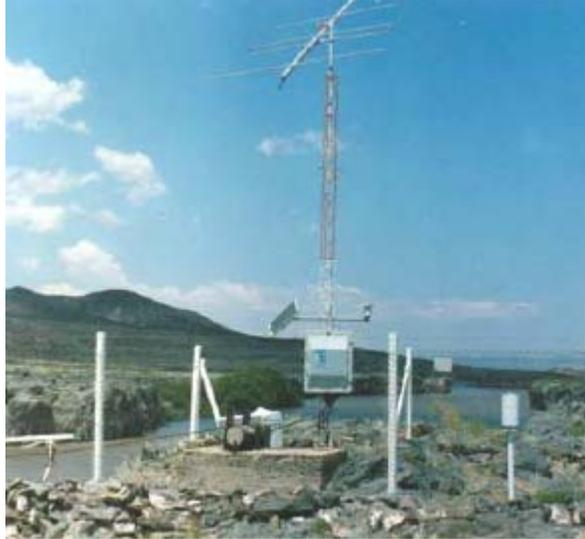
**Figura 4.4.3** Estación hidrometeorológica
