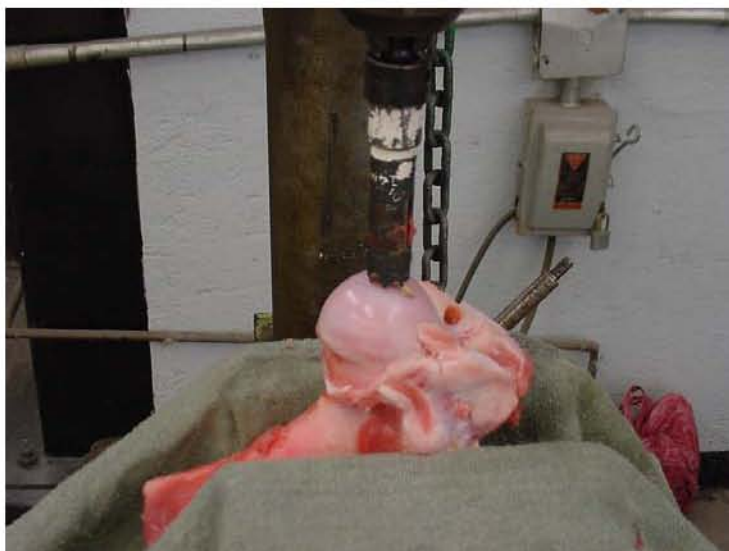
Figura 4.1 Obtención de probeta de compresión de hueso esponjoso.
