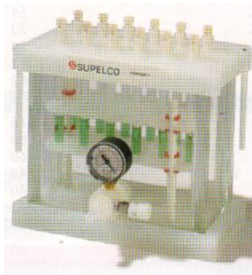
Figura 34. Distribuidor de vacío para cartuchos de EFS. En el se aplica un vacío que permite la rápida filtración de los disolventes y por ende un rápido fraccionamiento.
