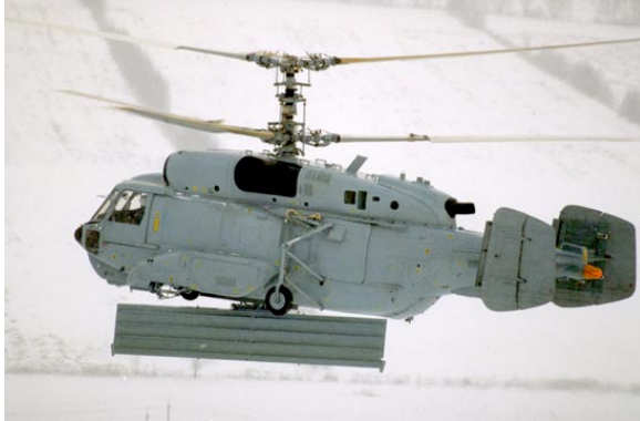
Fig. 4.16- Radar de alerta temprana E-801M OKO (ojo) que fue desarrollada por el “Nizhny Novgorod Radio Engineering Institute” de Rusia . Cuenta con una antena giratoria abatible [ www.airforce-technology.com/projects/ka3 ].
