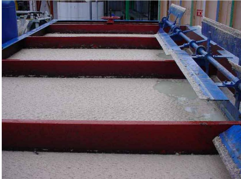
Figura C.15 Sistema de Flotación por Aire Disuelto (Dissolved Air Flotation DAF)
