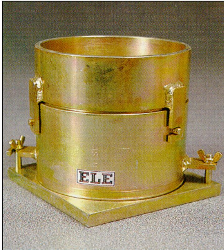
La diferencia fundamental entre el ensayo Proctor Normal y el Modificado estriba en la energía de compactación utilizada. Para los ensayos se utiliza una energía de unos 0,583 J/cm<sup>3</sup> para el Proctor Normal y unos 2,632 J/cm<sup>3</sup> para el Proctor modificado.
