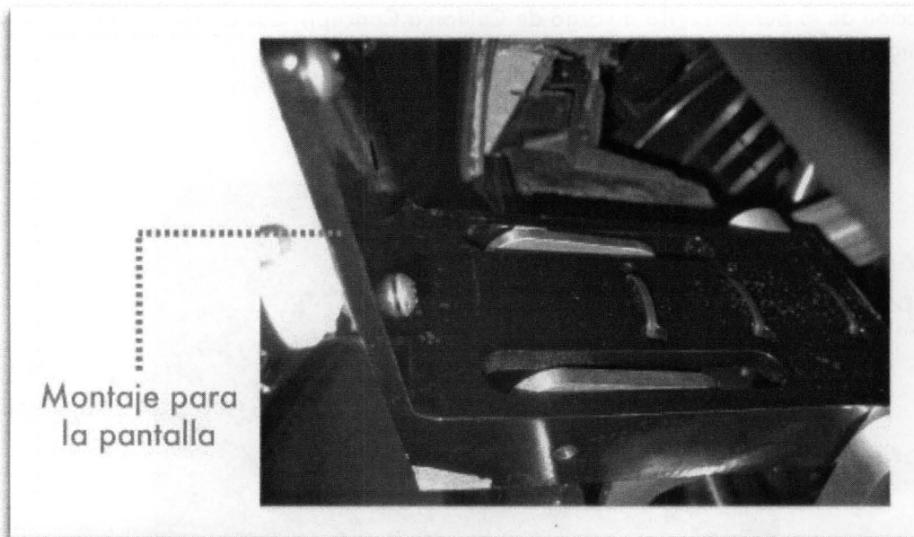
fig.111 · Vista Lateral del Montaje para la Pantalla
