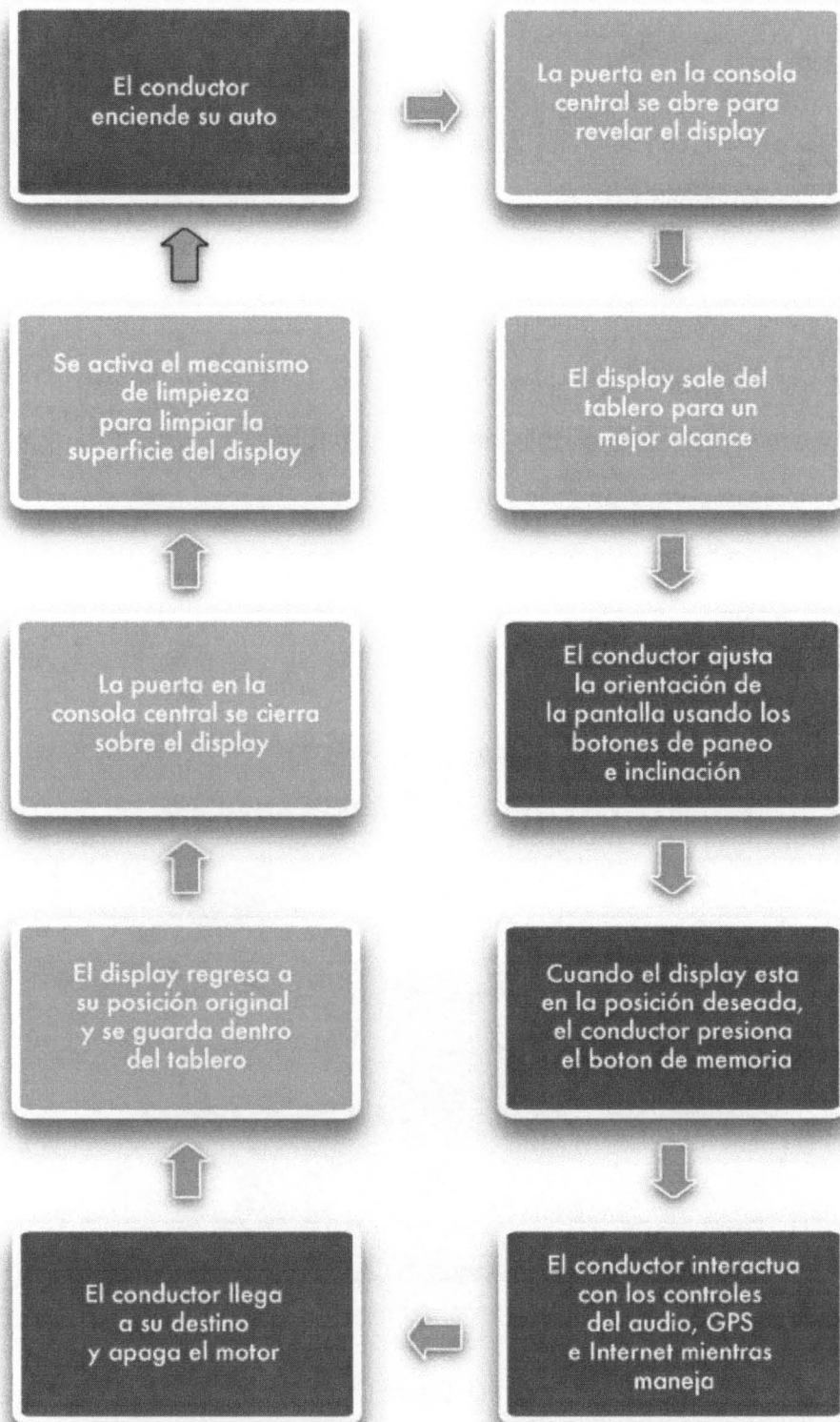
fig.91 · Funcionamiento del Sistema
