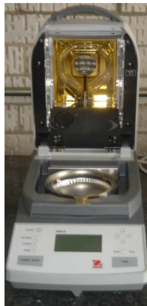
FIGURA 24. Esquema de analizador de humedad MB-45
