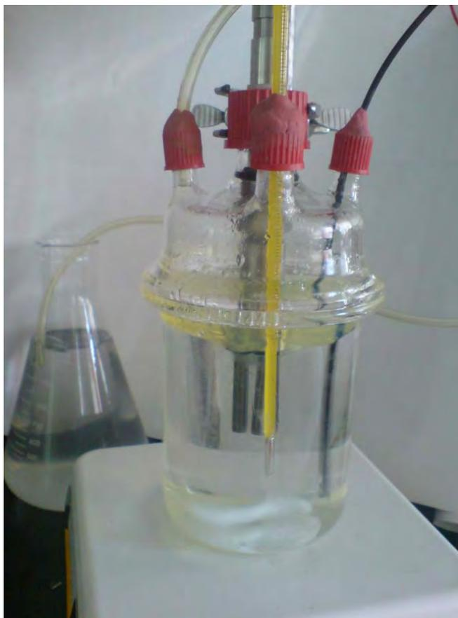
**Figura 2.6** Celda electroquímica con arreglo de 3 electrodos, para monitoreo de  $V_{corr}$  por LPR y HA.
