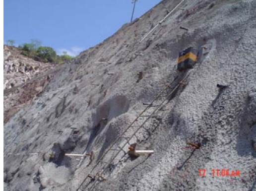
Figura 10.3-2. Extensómetro de barra a la elevación 330msnm, en posición horizontal.
