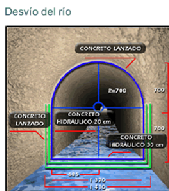
Figura 4. Túnel perteneciente a la obra de desvío.
