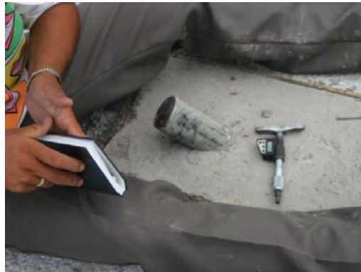
Figura 8.2-4. Monumento de concreto fijo al terreno y toma de la primera lectura con el micrómetro.
