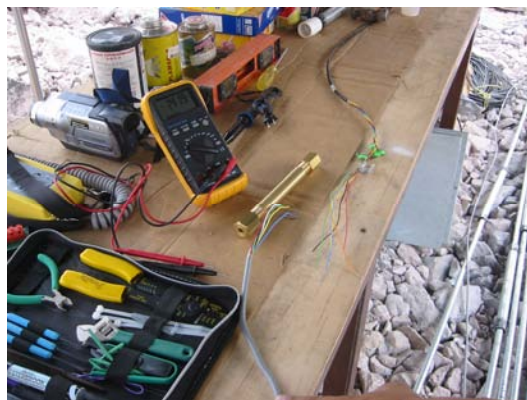
Figura 3.3-1. Mediciones de impedancia con el multímetro.
