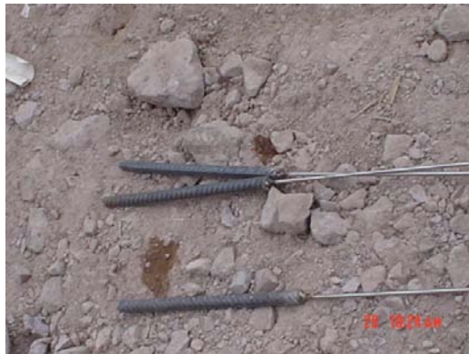
Figura 8.2-2. Anclas soldadas a las barras de acero inoxidable.
