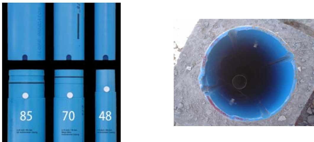
Figura 6.2.2-1. Inclinómetros de tubería ABS.
