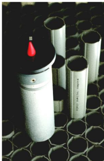
Figura 6.2.1-1. Inclinómetro de aluminio.
