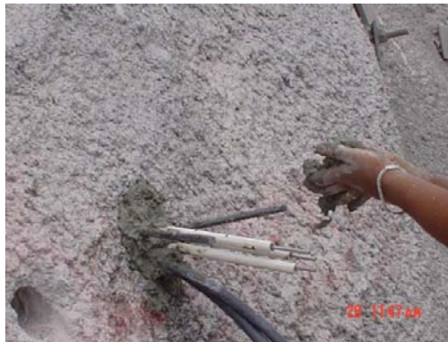
Figura 8.2-3. Instalación del extensómetro en el barreno, tapado con calafateada.
