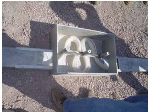
Figura 7.2-2. Caja de extensión con gasas de manguera.
