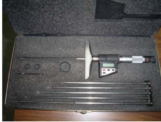
Figura 8.3-1. Micrómetro de medición de profundidades de precisión.
