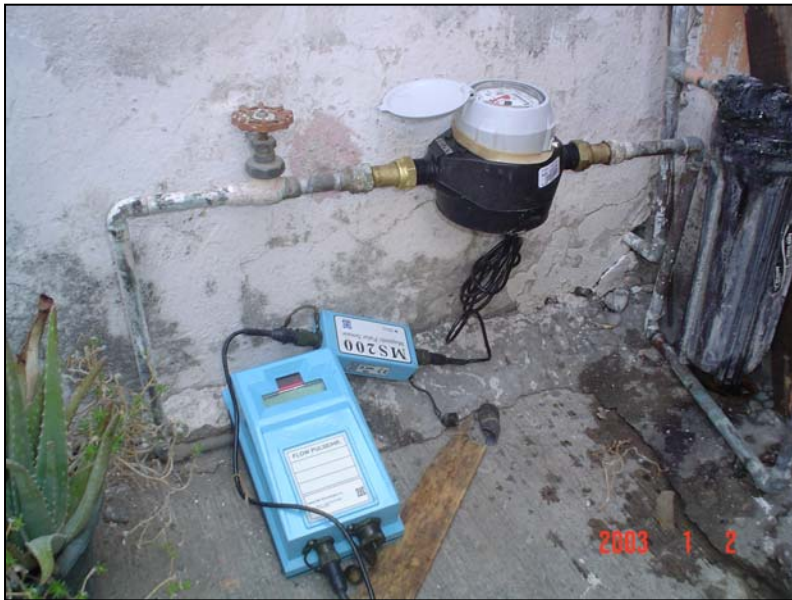
Ilustración 5-1 Arreglo de medición usado, compuesto de micromedidor, sensor magnético de impulsos y registrador.
