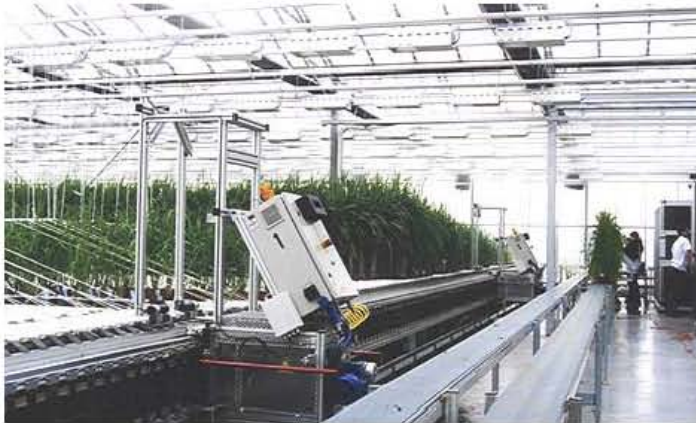
Instalación semiautomática para fotoperiodo con malla negra y aluminizada en la cara exterior
