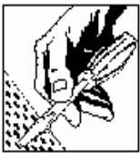
IP 3X Protegido contra el acceso a partes vivas con una herramienta de 2.5mm.Ø Protegido contra objetos sólidos extraños de 2.5mm.Ø en adelante.
