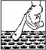
IP 2X Protegido contra el acceso a partes vivas con un dedo. Protegido contra objetos sólidos extraños de 12.5mm. Ø en adelante.
