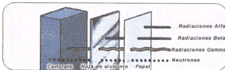
Figura 1. Radiaciones Alfa, Beta, Gamma [5]
