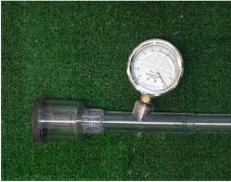
Figura 9. Tensiómetro
