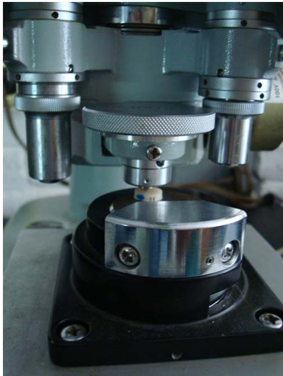
Figura 18 MEDICIÓN INICIAL DE LA DUREZA
