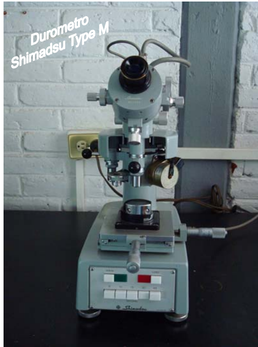
Figura 12 Durómetro marca Shimadzu Type M (Tokio, Japón)
