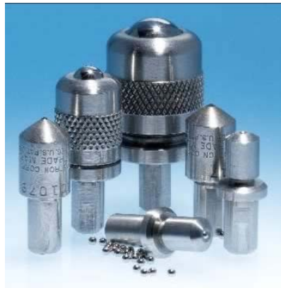
Fig. 4 DIFERENTES TIPOS DE INDENTADORES
