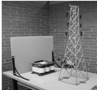
Acercamiento para observar el tablero con su transformador y torre para conexión lado generación.
