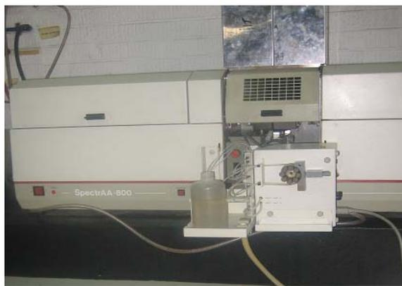
**Figura 2. Fotografía del equipo de espectrofotometría de absorción atómica.**
