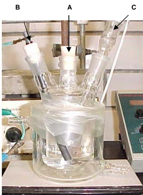
Figura 2.1. Celda típica de tres electrodos empleada para las electrolisis,
