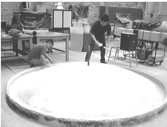
Secuencia 4. Acabado de la superficie: alisado, lijado, pintado y pulido con cera.
