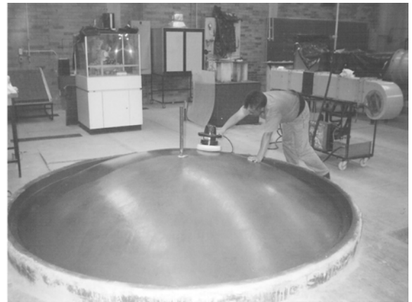
Secuencia 4. Acabado de la superficie: alisado, lijado, pintado y pulido con cera.
