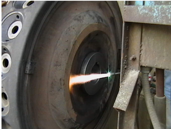
Figura. 4.3 Calentamiento del impulsor para su monta
