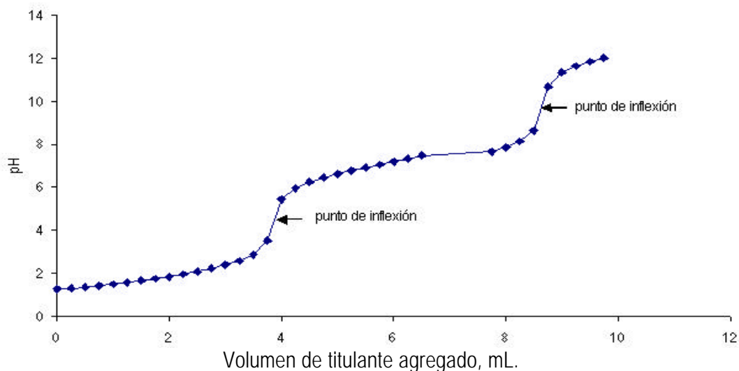
Figura 7a) Curva de titulación experimental de un ácido diprótico débil con una base fuerte en el plano pH/volumen. Se señalan dos puntos de inflexión debido a los dos protones del ácido valorado.
