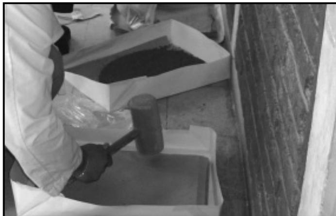
Figura 11. Molido de muestras con un mazo de madera
