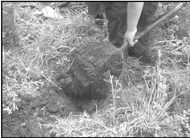
Figura 5. Toma de muestras de la capa arable con pala recta.
