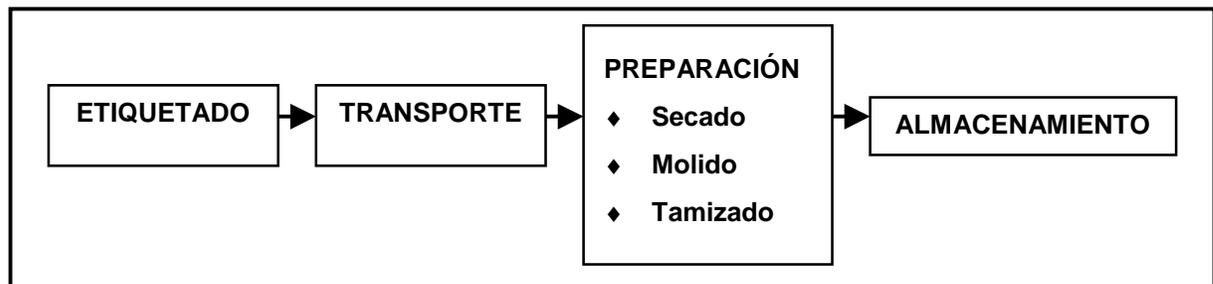
Figura 8. Diagrama del manejo de muestras.
