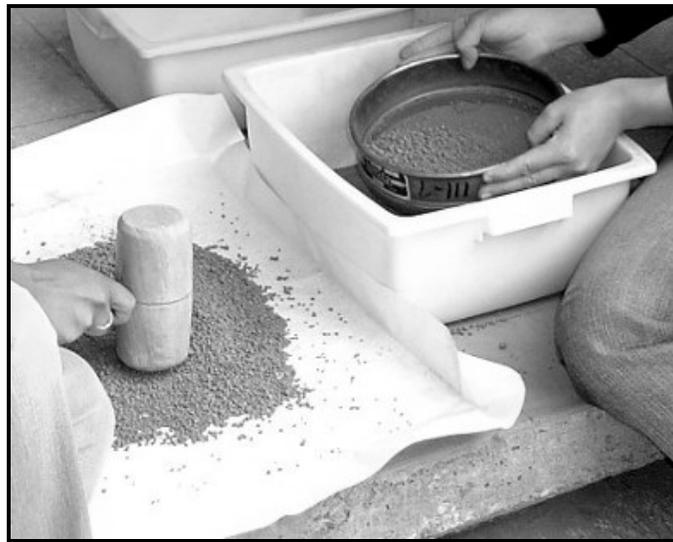
Figura 12. Tamizado de una muestra de suelo.
