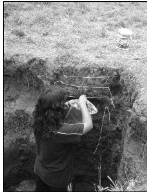
Figuras 6 y 7. Excavación de un pozo de muestreo y toma de muestras del perfil.
