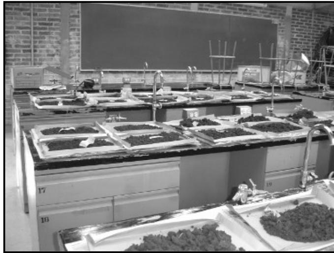
Figura 10. Secado de muestras de suelo
