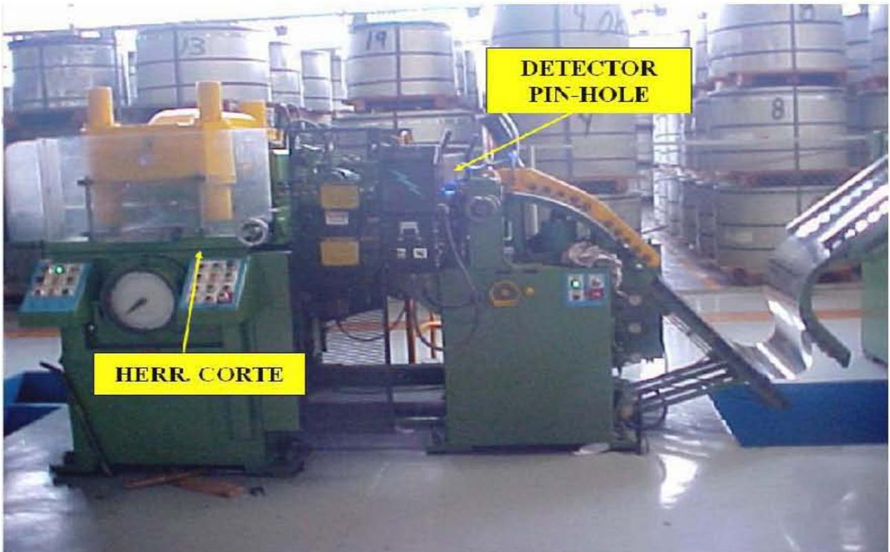
Figura 7.6 Detector de PIN-HOLE
