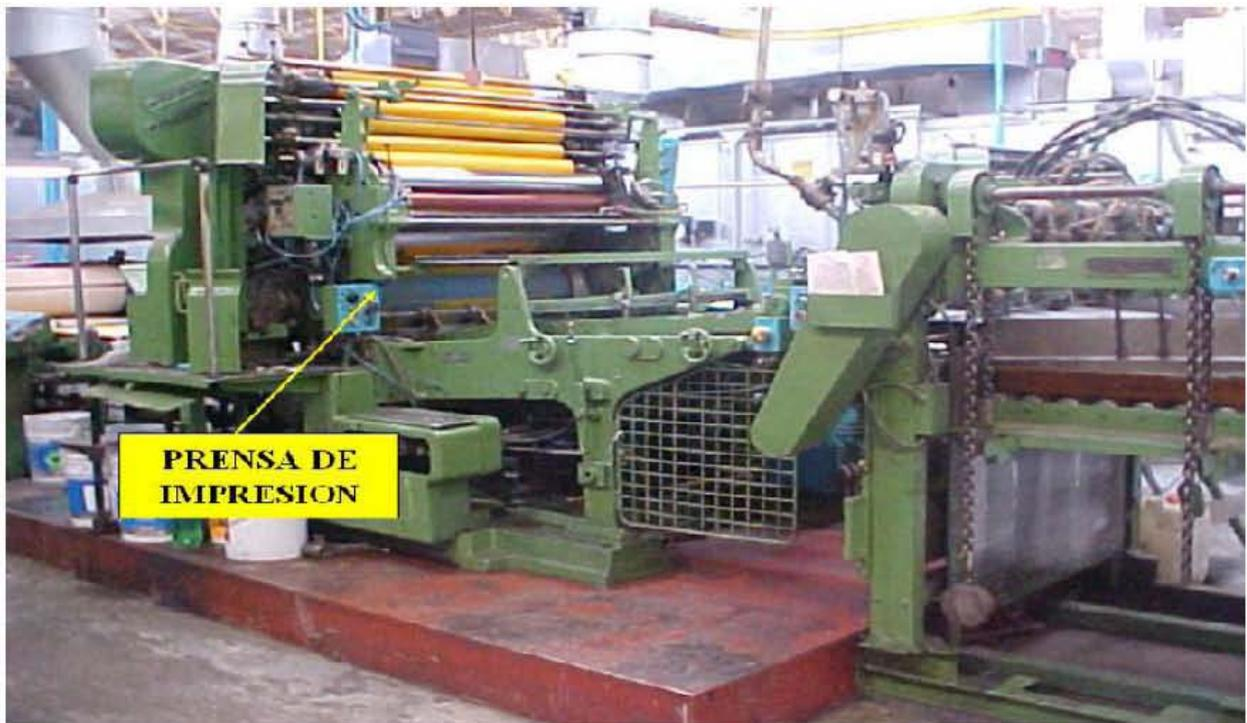
Figura 7.12 Prensa litográfica
