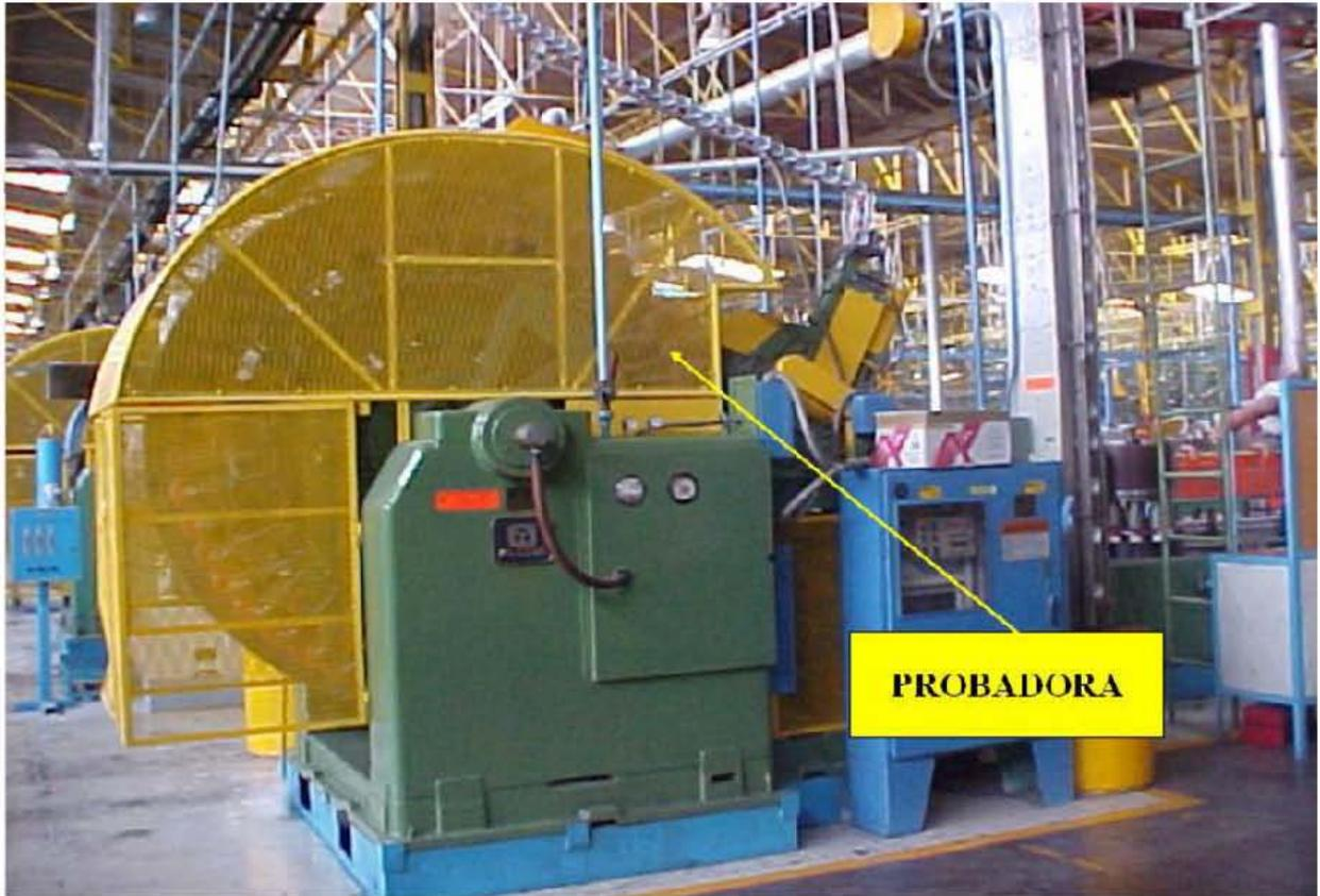
Figura 7.35 Chequeo de fugas
