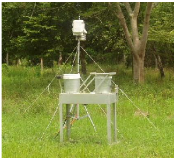
Figura 5.2. Estación meteorológica automática y colector automático para deposición húmeda y seca en el Campamento de Arqueólogos de la Zona Arqueológica de El Tajín, Veracruz.
