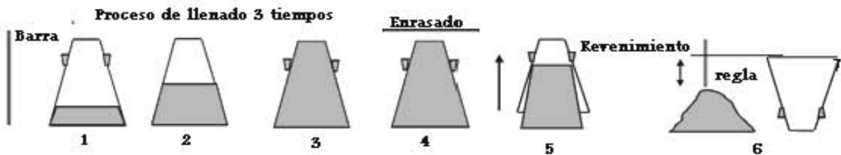
Fig. I.5 Obtención del revenimiento según la norma ASTM-C-143
