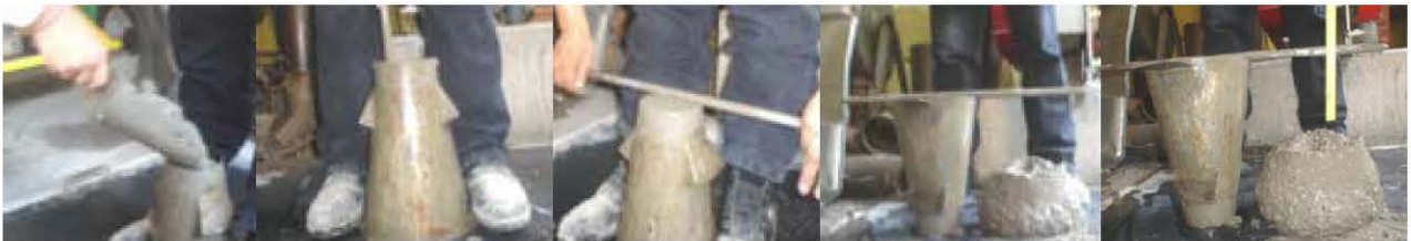
Fig. III.9 Prueba de revenimiento a una mezcla de concreto con HVFA
