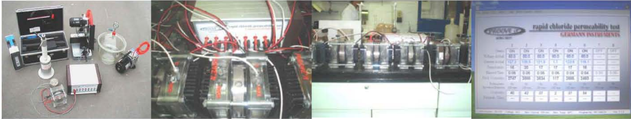
Fig. I.10 Prueba resistencia a la penetración del ion cloruro con un equipo marca Proove'it cumpliendo con lo estipulado en la norma ASTM-C-1202
