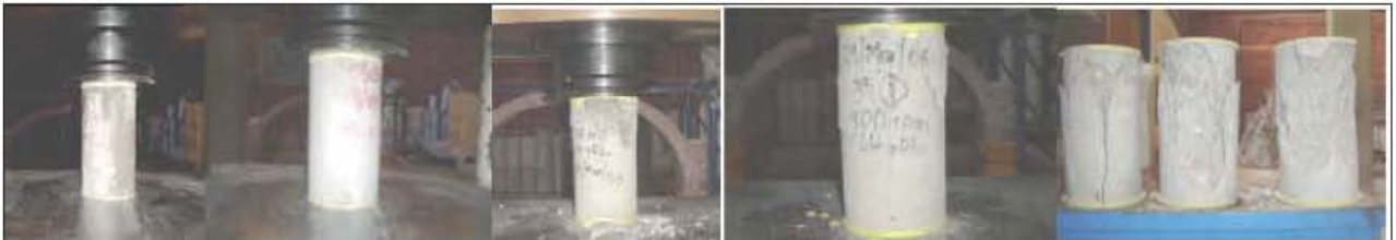
ESQUEMATIZACIÓN DE LA PRUEBA RESISTENCIA A COMPRESIÓN SIMPLE
