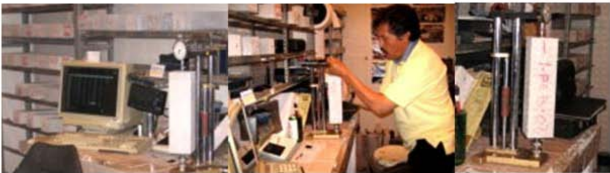
MEDICIÓN DE BARRAS PRISMÁTICAS DE CONCRETO DE ACUERDO CON LA NORMA ASTM-C-157
