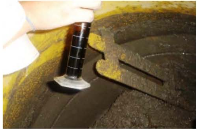
Fig. III.3 Colocación del aditivo a la mezcla
