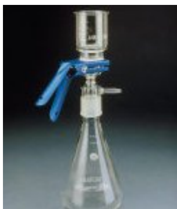
Fig. 3.2 Dispositivo de filtración.
