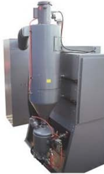
Figura 1.5 Vista posterior de una cabina de esmerilado
