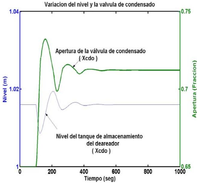
Gráfico 8.4 Variación del nivel del deareador y la válvula de condensado
