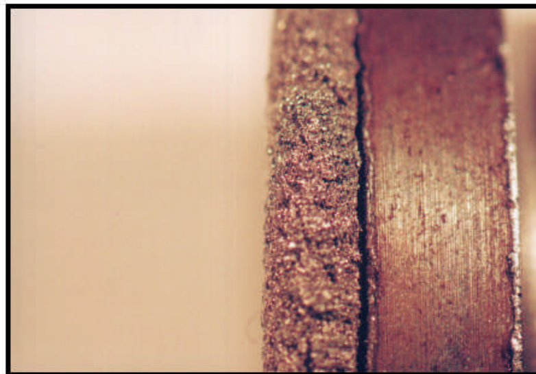
Fig. 5.2 Probeta con tiempo de rociado de 3 min. 10X (Vista lateral enfocando desprendimiento del recubrimiento)
