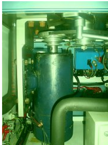
Fig. 4.7 Motor de imán permanente adaptado
