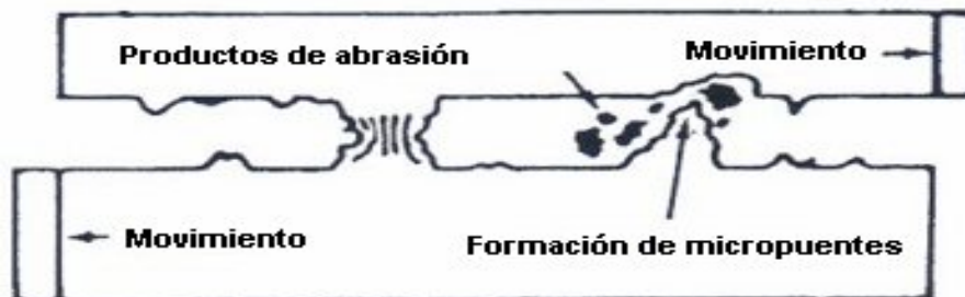
FIG. 2.3 Representación del desgaste adhesivo
