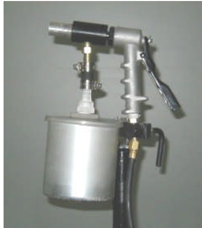
Fig. 1.11 Granalladora con sistema de succión que se utilizará en este trabajo.
