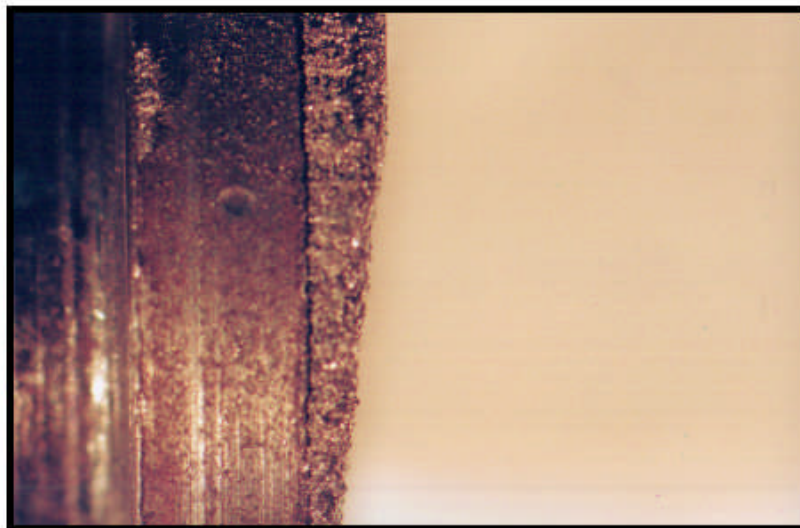
Fig.5.1 Probeta con 1.5 minutos de proyección, con mala distribución en proyección térmica. 8X (vista lateral)
