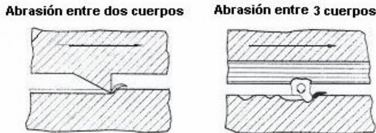
Fig. 2.8 Desgaste abrasivo entre dos y tres cuerpos.
