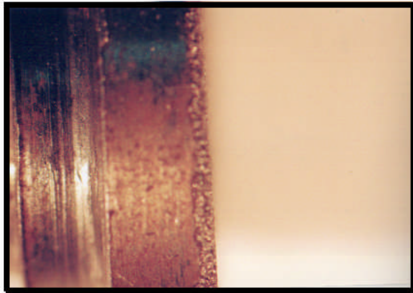
Fig. A.7 Probeta 2 c/ recubrimiento T. rociado=1.5 min sin carear c/ desgaste 8X (vista lateral)
