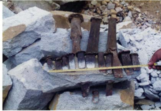
Foto No. 6.8 Herramienta utilizada para cantería, aun hasta el día de hoy. Arriba: Cuñas Cortadoras. Abajo: Cuñas de Escopladura Fuente: Autor, 1996
