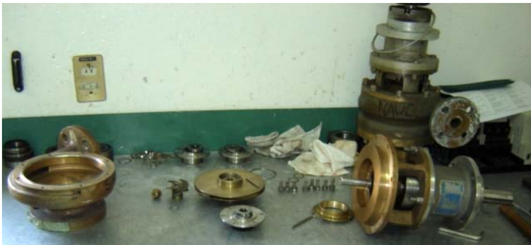
Figura 14. DESENSAMBLE DE BOMBA CENTRÍFUGA CRIOGÉNICA
