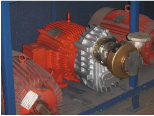
Figura 6-B. MOTOR ELÉCTRICO CON BOMBA CRIOGÉNICA ACOPLADA POR CAJA DE BANDAS
