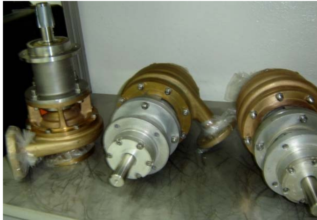
Figura 16. RACK DE BOMBAS CENTRÍFUGAS CRIOGÉNICAS
