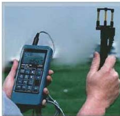
Figura 3.9 – Anemómetro ultrasonico utilizado: Anemosonic UA6
