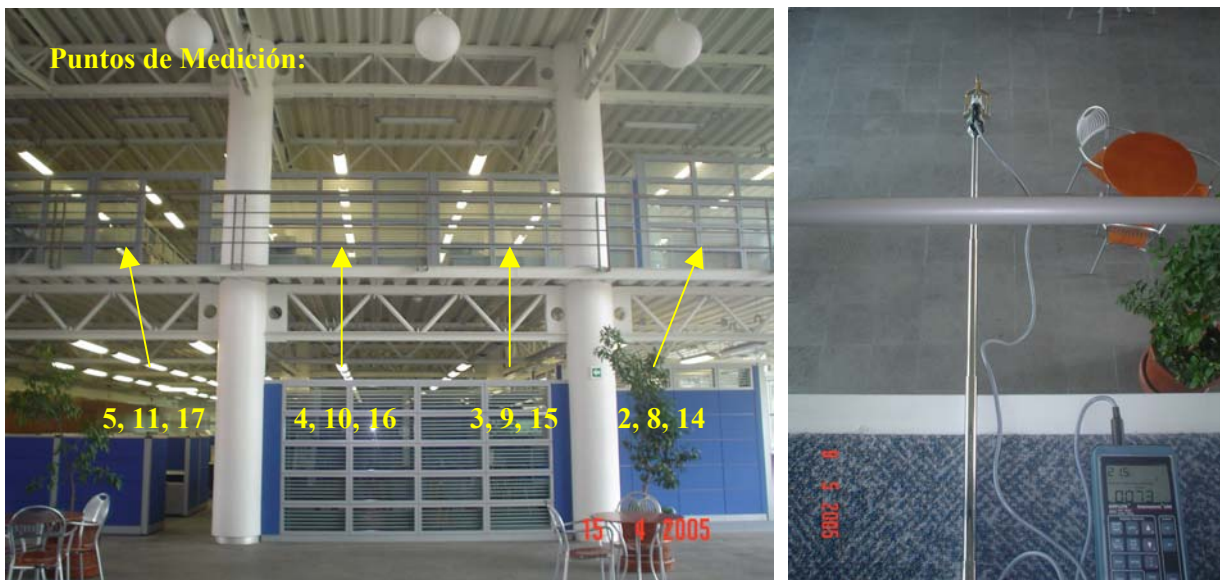
Figs. 4.5 (Izquierda) y 4.6 (Derecha). Posiciones en las cuales se realizó la medición de las velocidades en el atrio y posición utilizada para el sensor del anemómetro.
