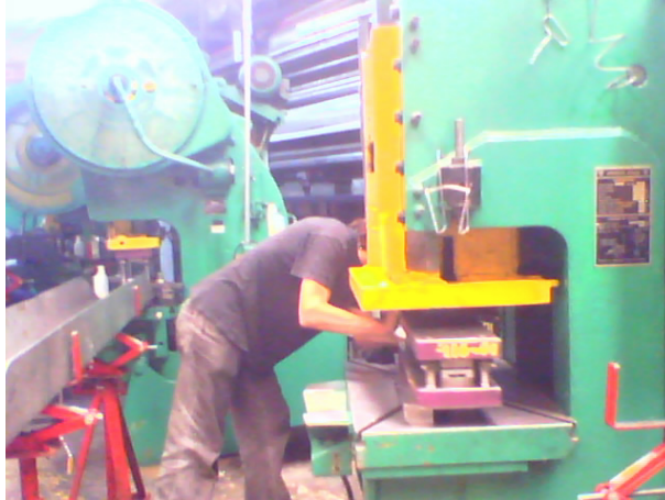
Figura 4.17 Operador colocando un troquel
