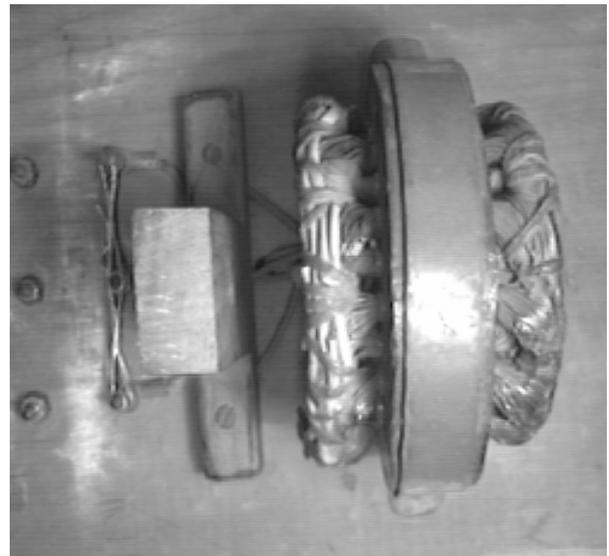
Figura 2.1.6. Estator de un motor de jaula de ardilla.
