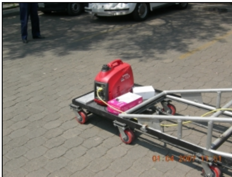
Figura 4.3. Colocación del generador en la estructura del perfilógrafo longitudinal.
