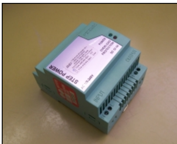
Figura 2.12. Fuente de alimentación del codificador angular.
