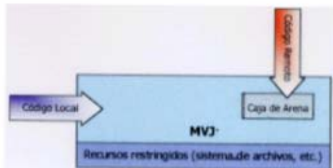
Figura 4 Modelo de seguridad del JDK 1.0.
