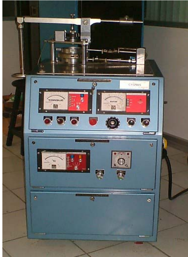
Figura 4.6 Máquina de Desgaste "Swansea Tribology Centre" marca CYGNUS.
