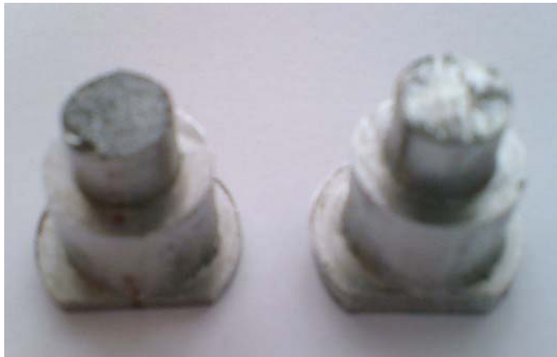
Fig. 5.18. Fotografía de la probeta en turno, a la izquierda sin desgastar y a la derecha ya desgastada.
