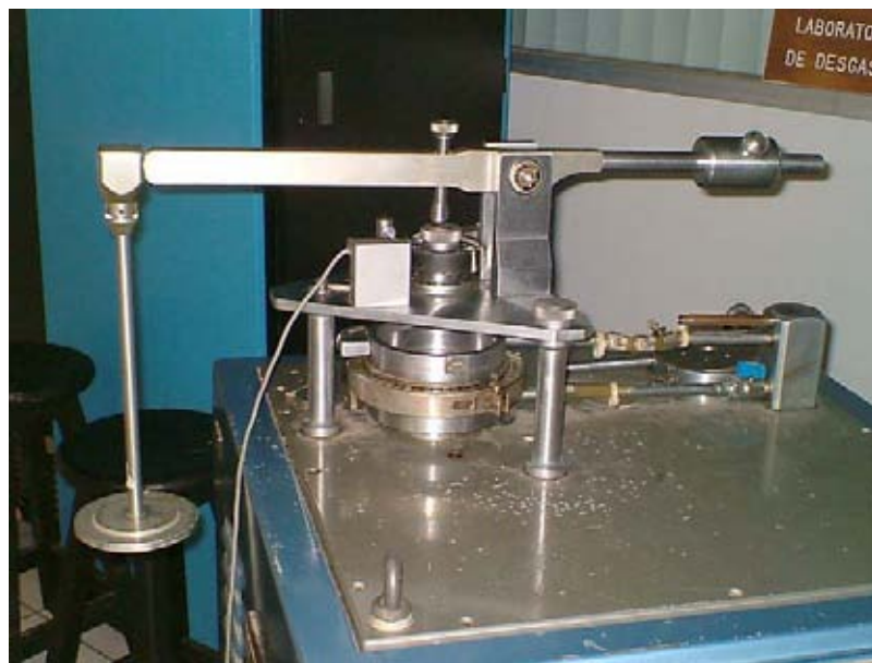
Figura 4.7 Brazo de contrapeso de la máquina de Desgaste.
