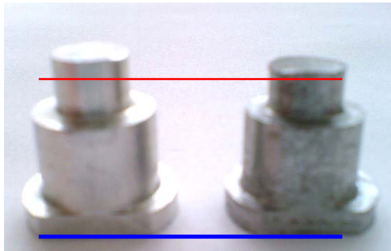
Figura 5.25. Diferencia de alturas entre una probeta de acero sin desgastar (izquierda) y una probeta desgastada (derecha). La línea azul es la base de ambas probetas y la línea roja indica el nivel de la base desgastada.
