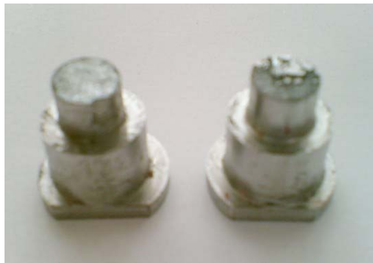
Figura 5.24. Fotografía de la probeta en turno, a la derecha probeta sin desgastar, a la izquierda probeta desgastada.
