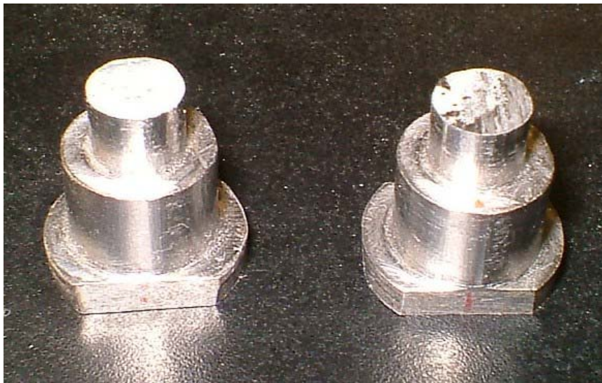
Figura 4.11 Recubrimiento desgastado después de 5 minutos, tiempo máximo en que se desgasta el recubrimiento del material base.
