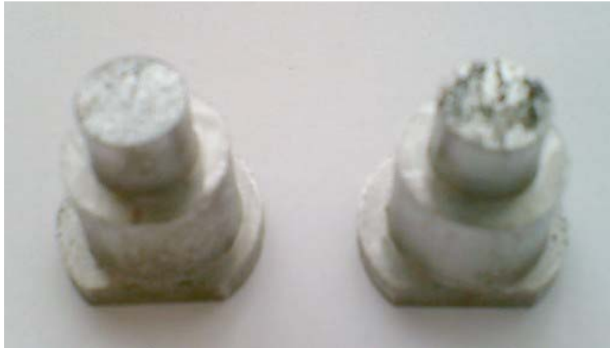
Figura 5.12. Fotografía de la probeta en turno, a la izquierda sin desgastar y a la derecha ya desgastada.
