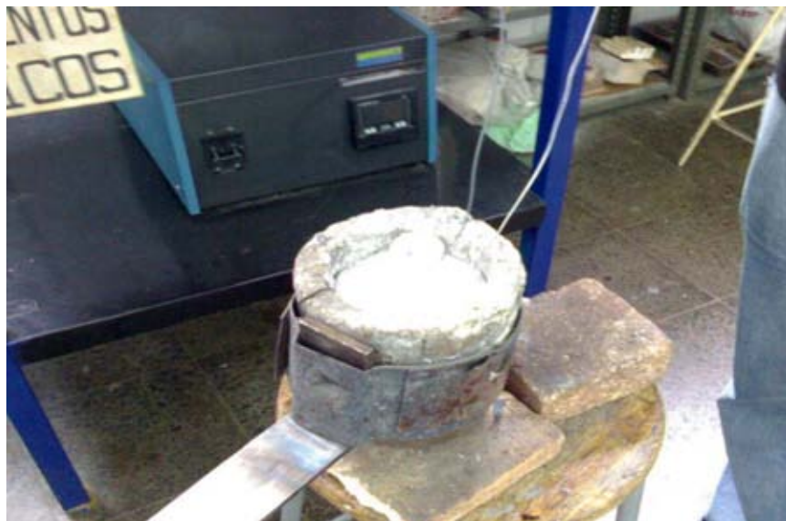
Figura 4.2 Se observan las probetas sumergidas en el baño de zinalco dentro del crisol.
