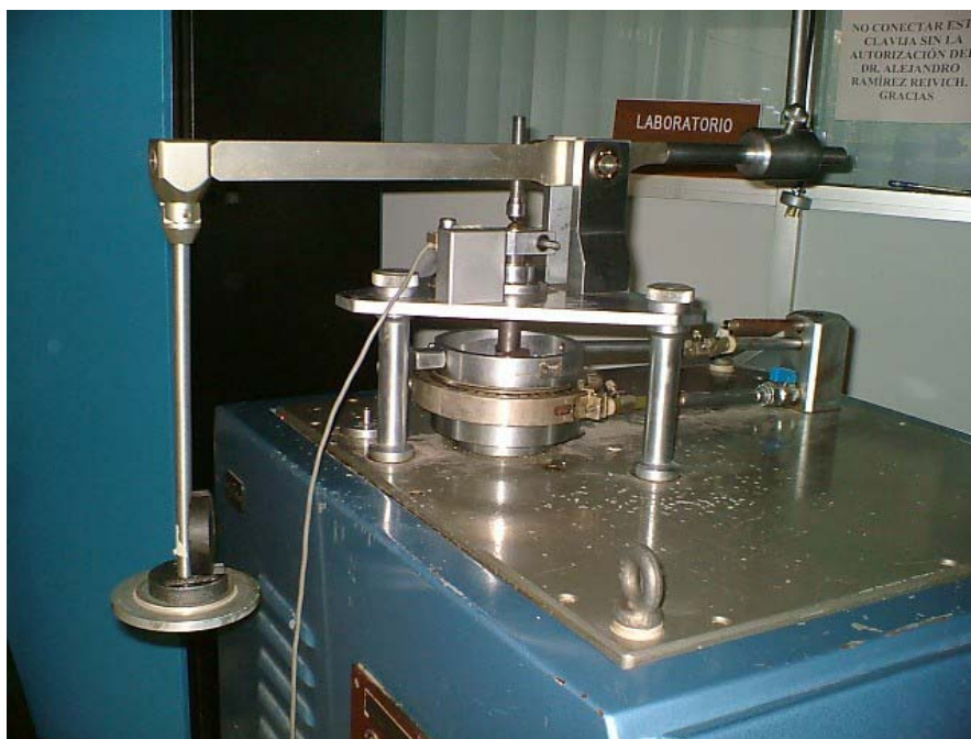
Figura 4.9 Brazo acoplado con pesas y porta probetas.
