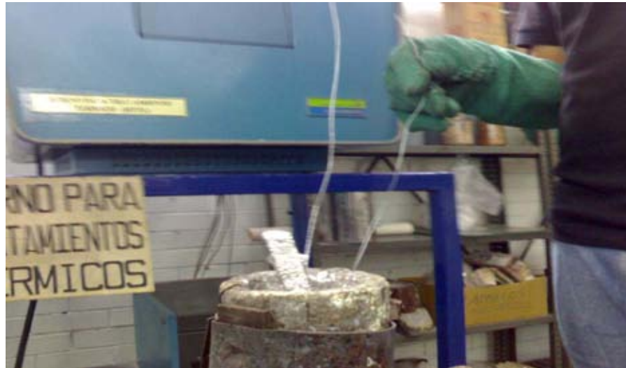
Figura 4.3. Se observan las probetas después del tiempo requerido dentro del zinalco fundido.
