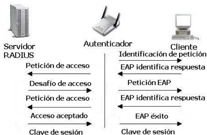
FIGURA 24. AUTENTICACIÓN MEDIANTE EL SERVIDOR RADIUS
