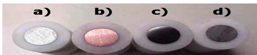
Fig. 2.2.- Electrodo de trabajo para disco rotatorio empleados para estudios de microelectrólisis. (a) aluminio, (b) cobre, (c) acero 1045 y (d) zinc.
