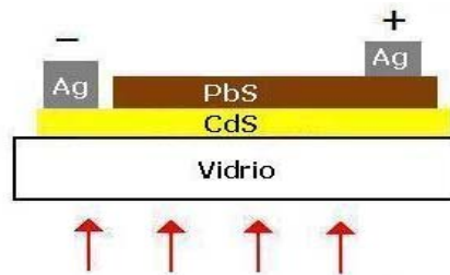
Figura III.3 Esquema de la estructura fotovoltaica CdS – PbS sobre vidrio.
