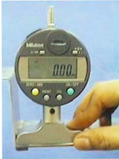
Figura 18. Micrómetro de profundidad
