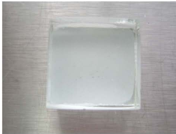
fig. 16 placas de vidrio con cemento
