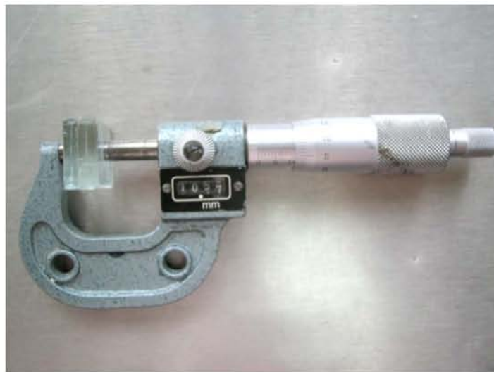
fig. 15 tornillo micrométrico con placas de vidrio
