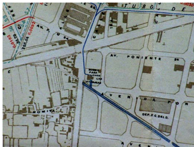
Imagen 140. Detalle del plano en donde se observa el puente de la Piedad, y el brazo del canal que se conecta con el canal de la Derivación, que va a cielo abierto. También se distingue el área de las bombas para lavar las atarjeas.
