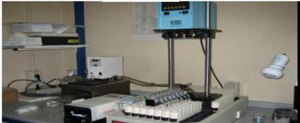
Figura 16. Equipo de celdas de flujo continuo de Franz. En la parte superior, se muestra un dibujo en el que se aprecian el compuesto donador y el receptor y la celda de flujo continuo que contiene el compuesto receptor, indicada con la flecha (muy pequeña comparada con la celda del equipo estático). En la parte inferior de la figura, el equipo de celdas de flujo continuo del laboratorio de Galénica de la Universidad Complutense de Madrid. Se aprecian la bomba para regular el flujo a través de las celdas y el baño de agua para el control de la temperatura de 37\text{ }^{\circ}\text{C} \pm 0.5 .
