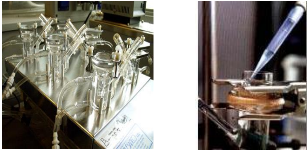
Figura 15. Equipo de celdas fijas de Franz. En la figura del lado izquierdo se muestran 6 celdas de vidrio conectadas a un baño de agua para mantener la temperatura a 37\text{ }^{\circ}\text{C} \pm 0.5 . En la figura del lado derecho se muestra una celda con la membrana de abdomen ratón instalada y la colocación de la muestra antes de la prueba.
