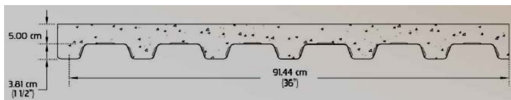
Figura 3.2 Geometría de la sección transversal
