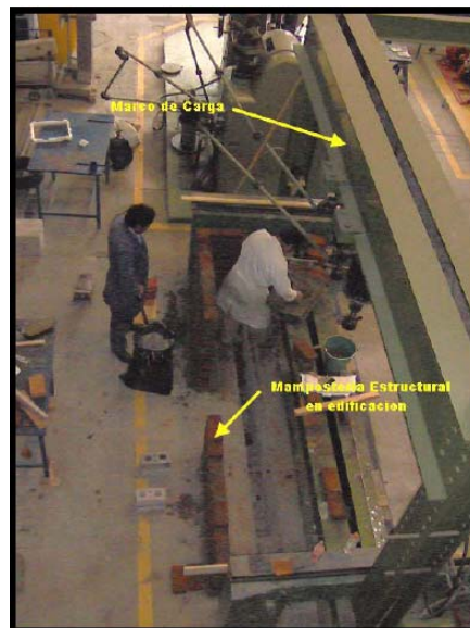
Figura 4.3 Proceso de construcción del sistema de apoyo
