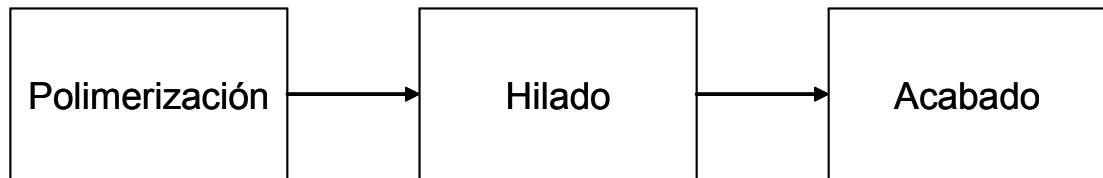
Figura 17. Proceso de manufactura FPT simplificado.
