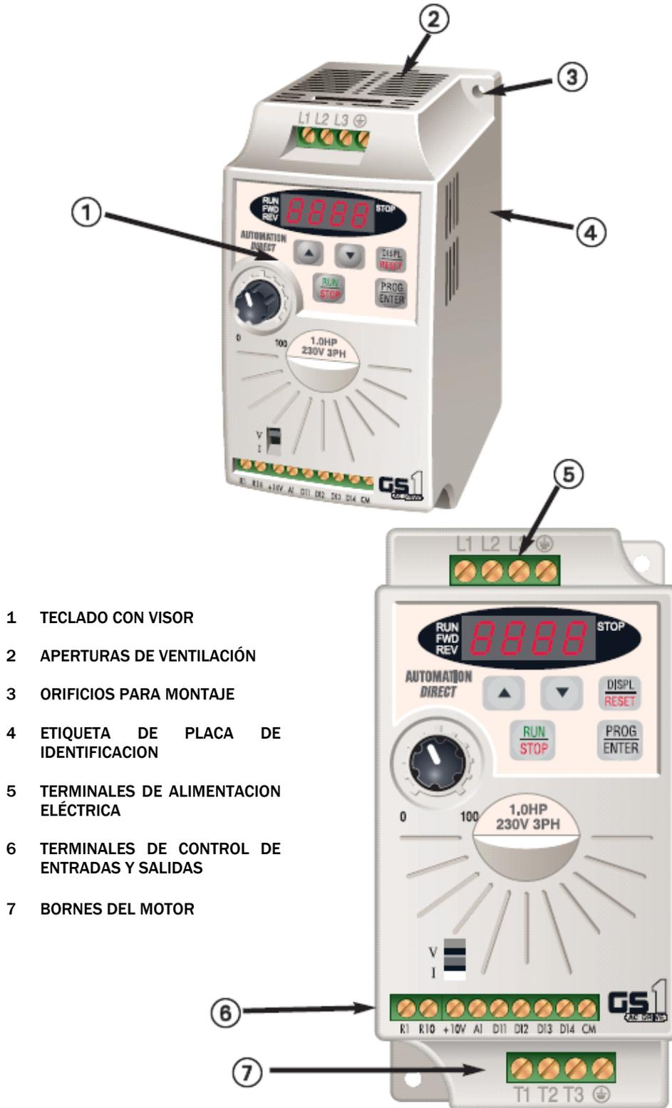
Figura 3.32. Principales partes de un controlador de frecuencia variable (VFD).
