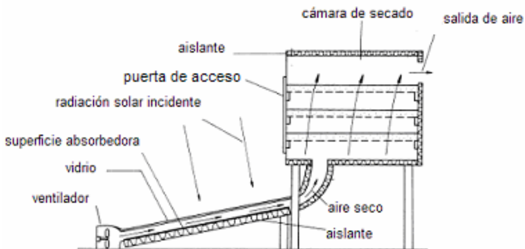
Figura 2.16. Características de un típico secador solar tipo distribuido [15].
