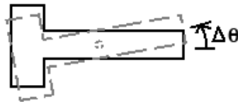
Figura 6.12: Ejemplo de una distorsión angular para las imágenes del conjunto de entrenamiento destinadas al PCNC.
