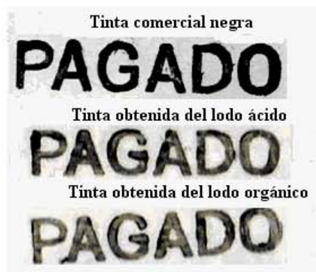
Figura 40: Comparación de la coloración entre la tinta comercial y las tintas obtenidas
