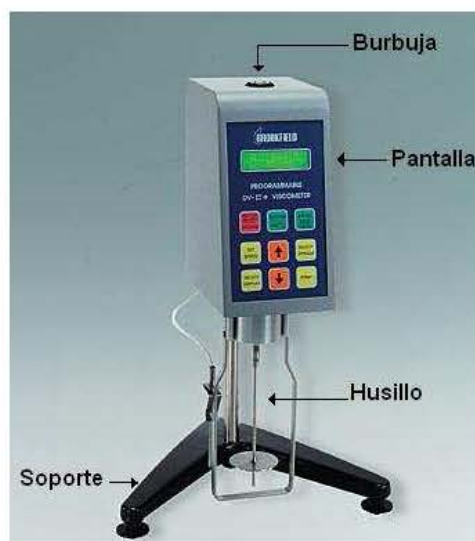
Figura 11: Esquema del viscosímetro Brookfield
